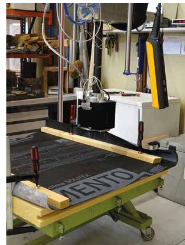
Mit einer Hagelkanone können Eiskörner mit Geschwindigkeiten von bis zu 110 km/h verschossen werden.
