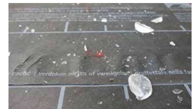
pro clima Unterdeckbahnen weisen auch nach mehrfachem Beschuss mit den größtmöglichen Hagelkörnern keine Beschädigungen auf und sind nach wie vor wasserdicht.
