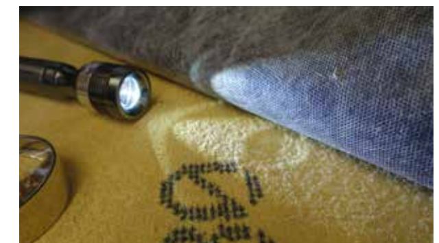
Die darunterliegende Holzfaserplatte hat nach Beschuss mit 50 mm Hagelkörnern eine ca. 4 mm tiefe Delle.
